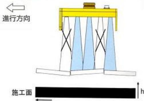
5個の超音波センサーで、検出した路盤との距離を平均します。
